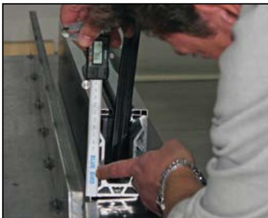
**CONCLUSIONS:** Sur la base du test effectué, des résultats obtenus et de ce qui est indiqué dans le tableau 3.1 II du D.M. des Infrastructures du 14/01/2008, l'échantillon analysé, constitué d'un garde-corps, est conforme aux prescriptions du D.M. des Infrastructures du 14/01/2008 dans la limite de la charge statique linéaire horizontale.
