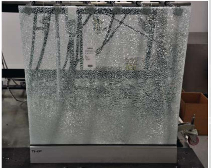
Image de rupture d'une plaque en 10+10+1,52, SentryGlas®, verres trempés. Fixations ponctuelles avec étrier SB200K entraxe  $l=800\text{mm}$ . Hauteur du plan de marche  $H=1000\text{mm}$  et largeur  $L=1600\text{mm}$ . Charge de rupture égale à  $3.17\text{ kN/m}$ . Test effectué selon certains critères repris de la UNI 10806:1999
