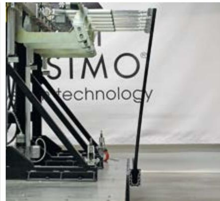
Déformation à 3 kN/m de poussée
