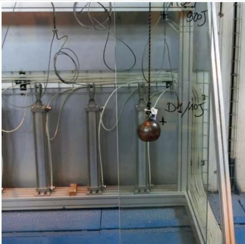
**4 - D1/10J - Impact avec un corps dur (bille en inox de 1 kg) avec énergie de 10 Joules;** le corps est lâché d'une hauteur de 1.016 m en correspondance du point d'impact situé au centre géométrique de la plaque et près d'un angle à 0,25 m des bords. Le système ne doit pas être traversé par le corps, ni produire débris ou écailles.
