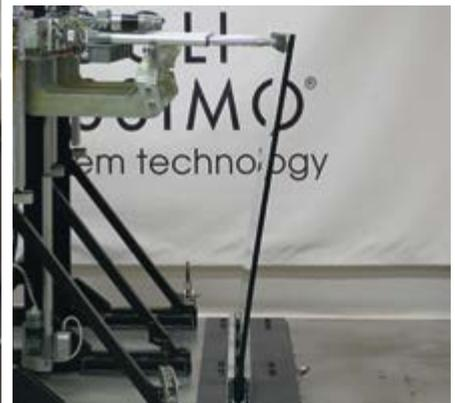
Déformation à 2 kN/m de poussée
