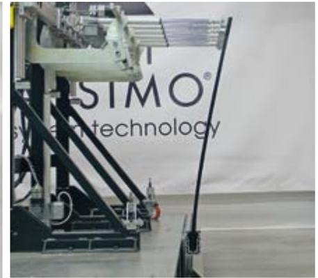
Déformation à 3 kN/m de poussée
