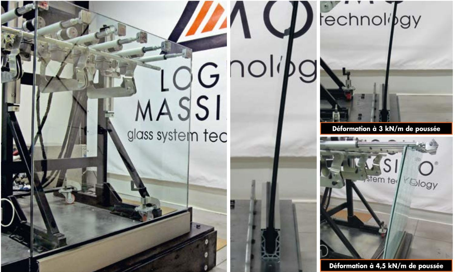
**RÉSISTANCE À LA CHARGE STATIQUE HORIZONTALE DU GARDE-CORPS SELON LE D.M. SUR LES INFRASTRUCTURES DU 14/01/2008**
