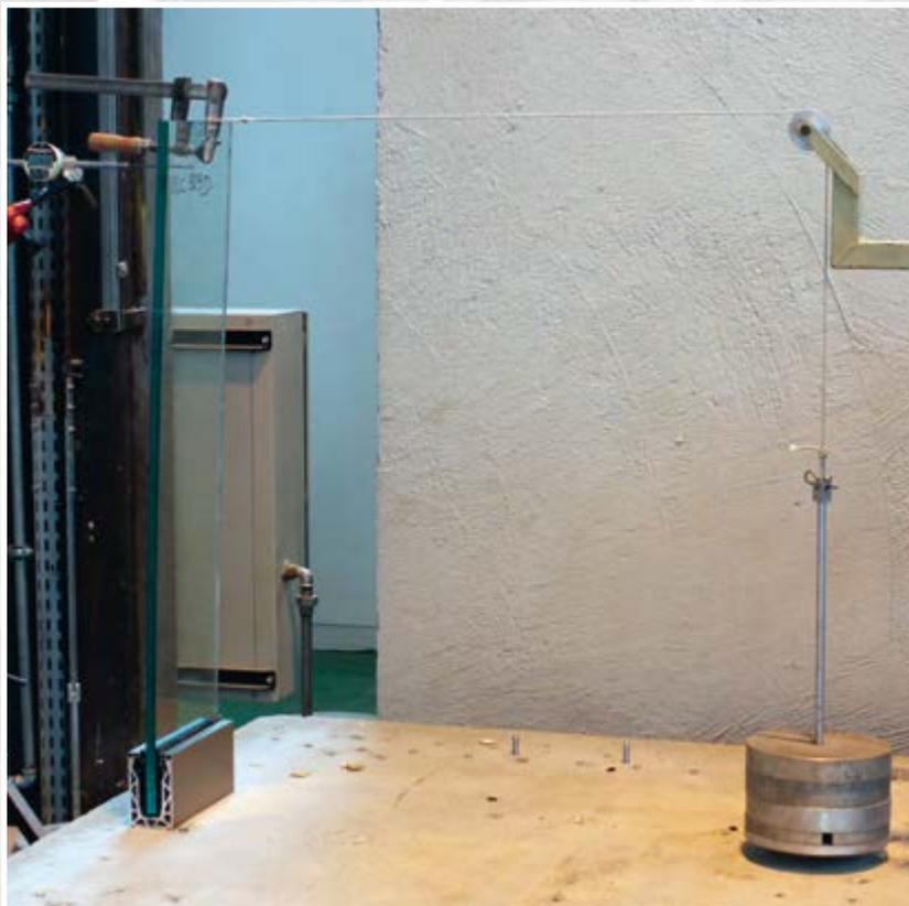
**Phase 2** - Poussée horizontale vers l'intérieur, masse 40 kg ponctuelle; la charge d'une masse de 40 kg est appliquée pour 1 minute à la moitié de la largeur de l'élément sur la rive supérieure. La déformation résiduelle, 15 minutes après la suppression de la charge doit être inférieure ou égale à 2mm.
