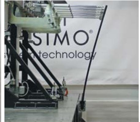
Déformation à 3,6 kN/m de poussée
