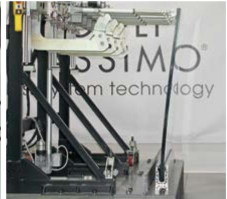
Déformation à 3 kN/m de poussée
