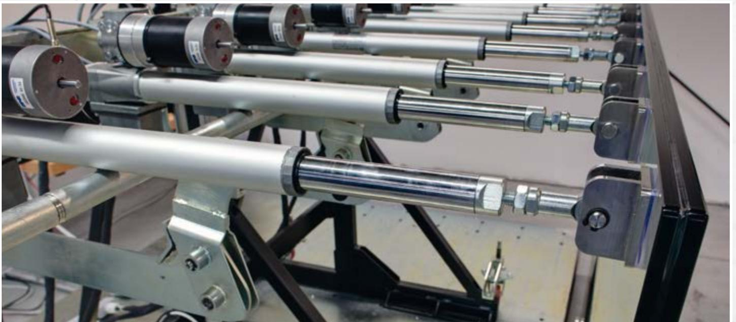
Machines pour la vérification de la résistances des garde-corps en verre et des parois en verre. La flexibilité du matériel permet également de faire d'autres tests, en l'adaptant à chaque fois pour l'utilisation nécessaire. Il a été conçu pour obtenir une distribution uniforme de la charge de poussée grâce à des actionneurs électromécaniques, chacun munis d'une cellule de charge propre.
