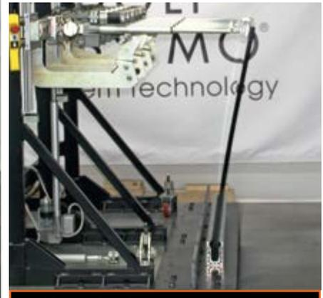
Déformation à 4,5 kN/m de poussée
